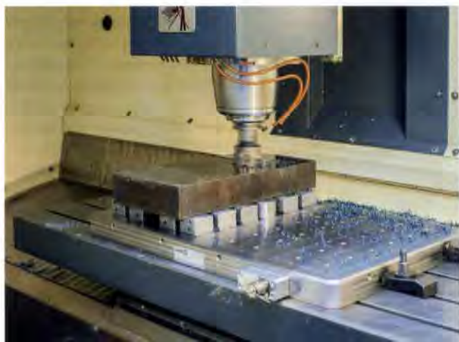
Die Vollmetall-Ausführung der »Premium Line« Magnetspannplatten von AMF widersteht heißen Spänen und aggressiven Kühlschmiermitteln.
